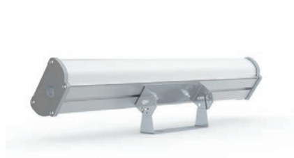
V4-10-70.0087.IR0-0001 Поворотное крепление для 1 светильника Размер крепления 192x45x80мм Угол поворота 180°, шаг 15°
